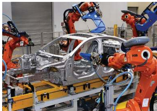
Gambar 2.4 Teknologi pengelasan robot dalam pembuatan kendaraan. Sumber: Crowe, 2018
