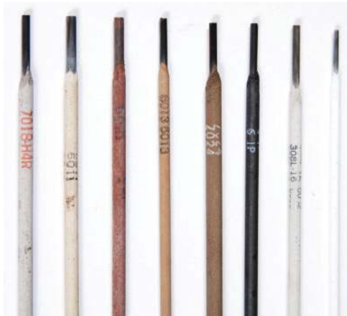
Gambar 8.1 Contoh kode huruf dan angka pada elektroda
