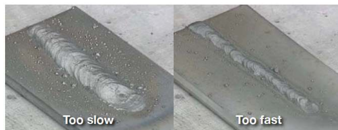
Gambar 8.8 Perbedaan kecepatan pengelasan tinggi dan rendah
