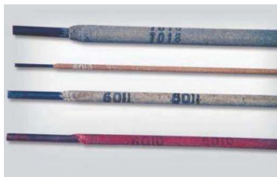
Gambar 8.2 Identifikasi kode warna pada elektroda
