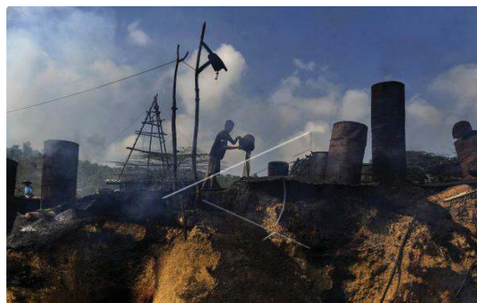
Gambar 2.6 Proses Penyulingan Tradisional/Sederhana Minyak Bumi Sumber: Antara Foto/Zabur Karuru (2016)
