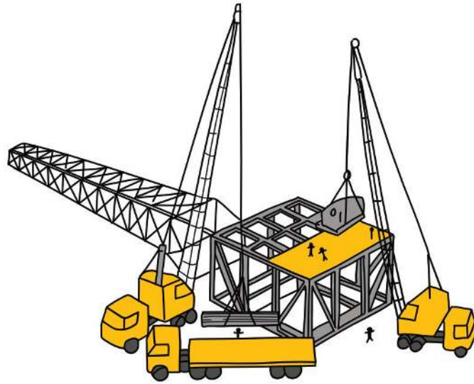
Gambar 5.15 Penyusunan Peralatan Sub-structure
