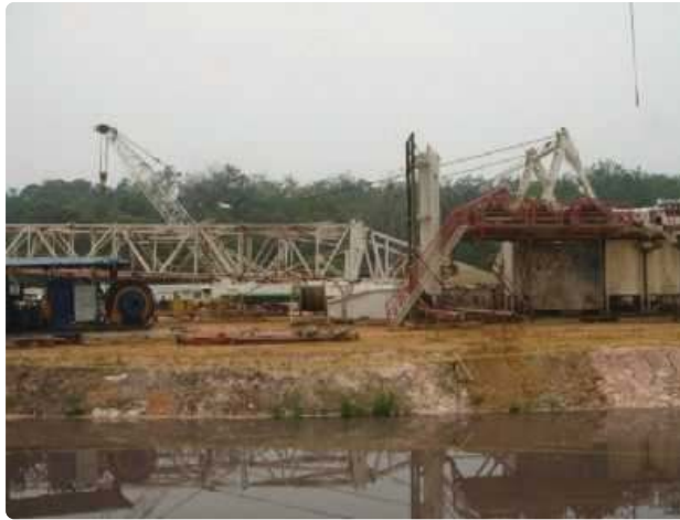
Gambar 6.7 Bagian Dasar dari Menara Diangkat ke Lantai Rig Sumber: PPSDM Migas Cepu/Susilo (2012)
