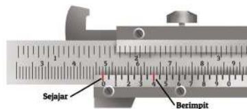
Gambar 4.4 Cara pengukuran mistar geser
