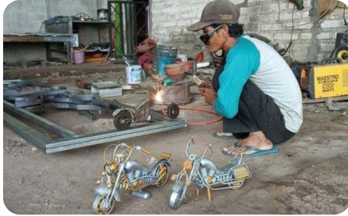
Gambar 1.8 Pekerja sedang Melakukan Pengelasan Benda Kerja
