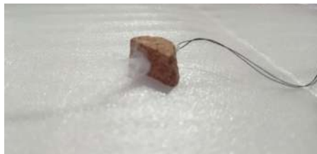
Gambar 5.4 Contoh Uji Pengujian Mikroskop Penampang Melintang
