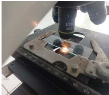
Gambar 5.6 Meletakkan Contoh Uji di Mikroskop
