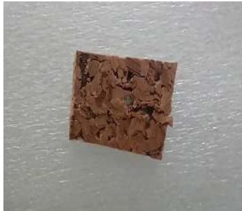
Gambar 5.5 Contoh Uji Pengujian Mikroskop Penampang Melintang Sudah Diiris
