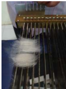
Gambar 5.9 Meletakkan Contoh Uji pada Sisir bawah
