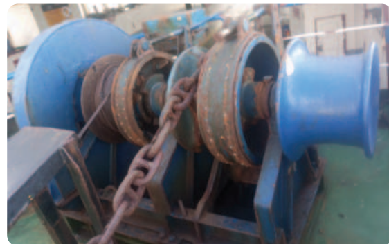
Gambar 9.27 Mesin jangkar Sumber: Ryanmizard (2024)
