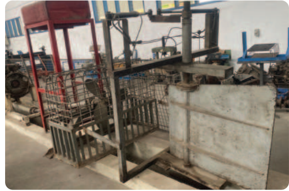
Gambar 9.28 Mesin kemudi kapal Sumber: Dudi Rachadi/Kemendikbudristek (2024)
