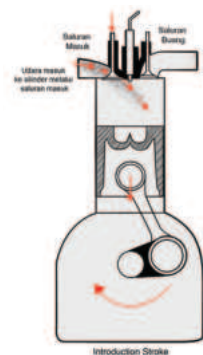
Gambar 9.5 Langkah hisap mesin diesel 4 tak
