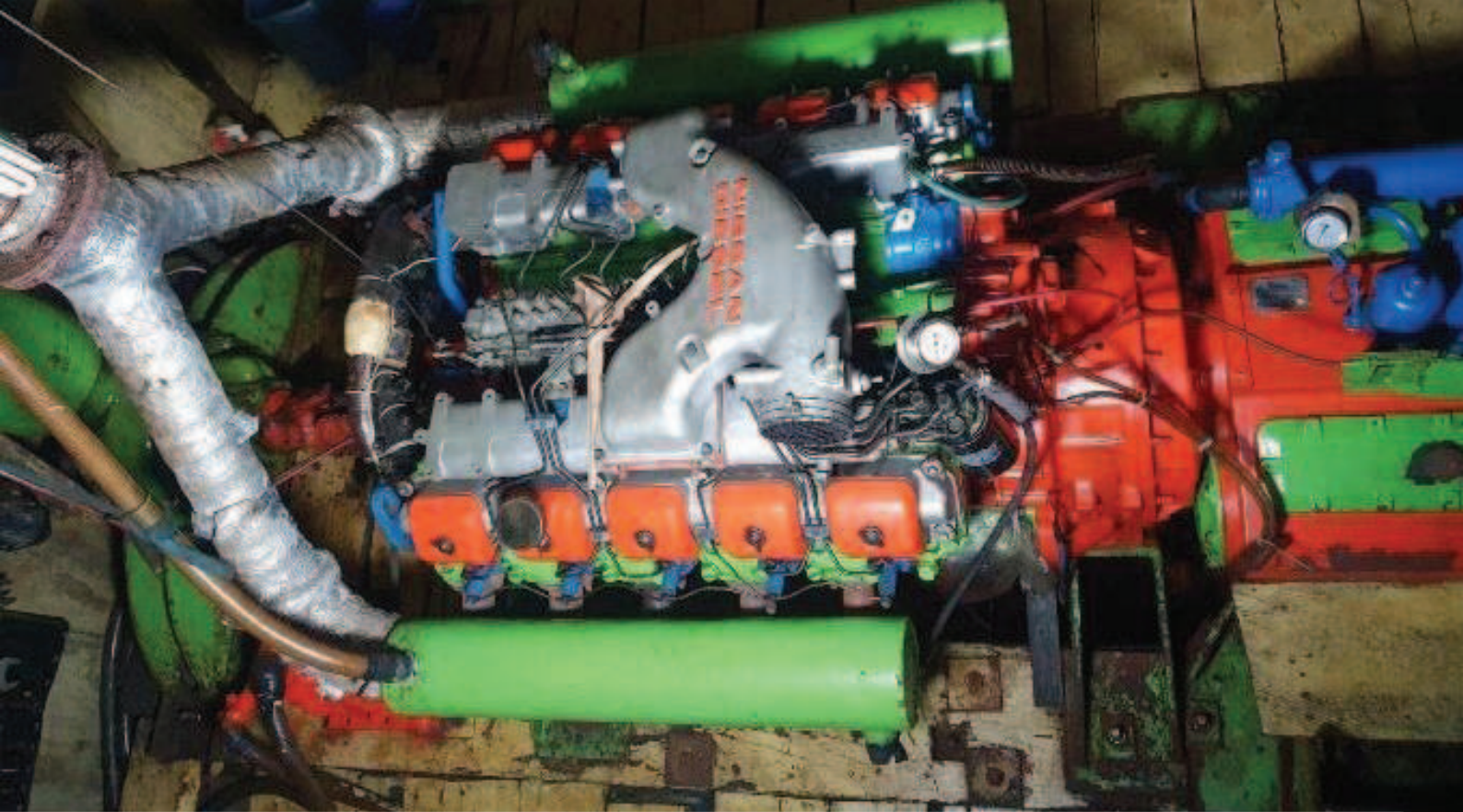
Gambar 9.1 Mesin penggerak utama kapal penangkap ikan Sumber: Saiful (2024)
