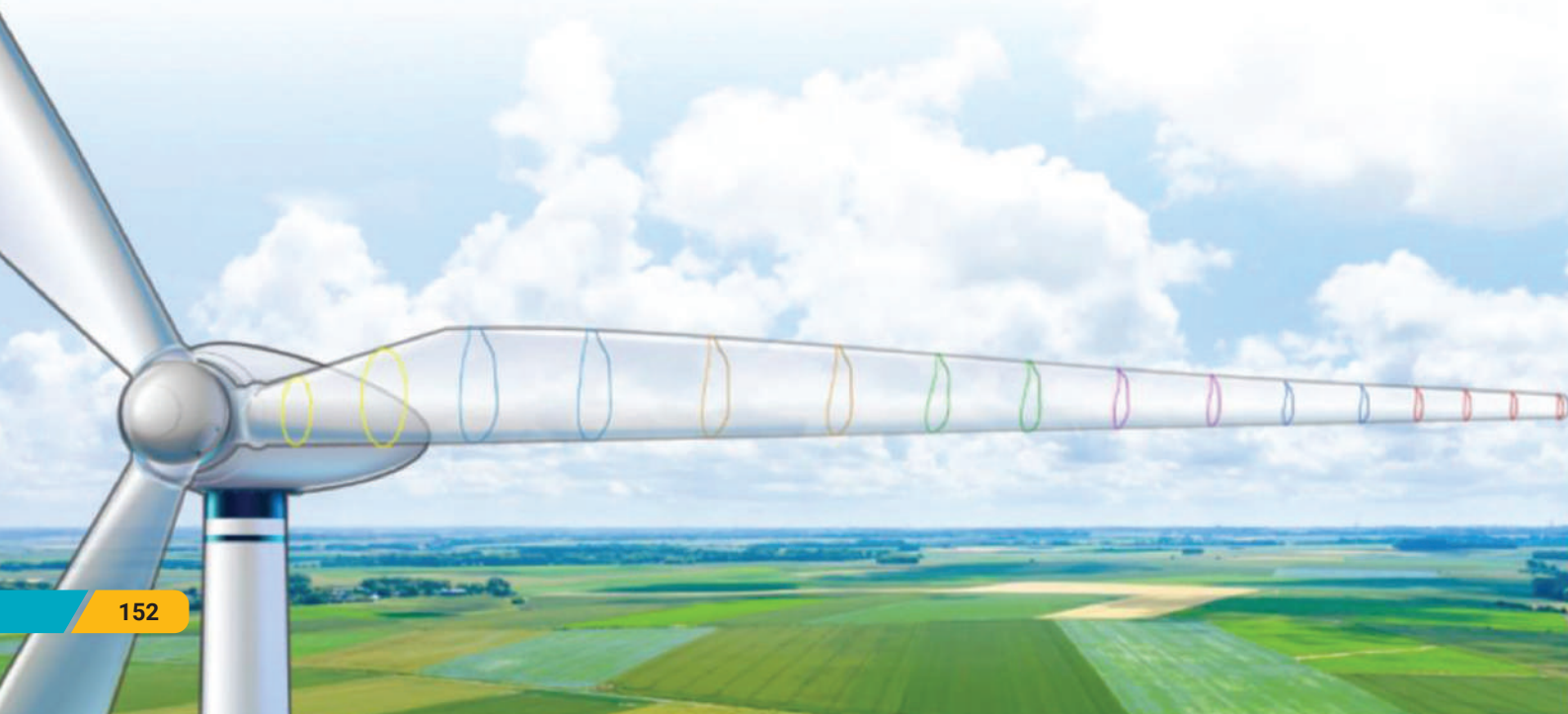
Gambar 3.10 Pembagian Posisi Airfoil pada Bilah Turbin PLTB Sumber: Al Hicks/www.energy.gov (2023)
