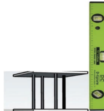
Gambar 3.70 Penggunaan Waterpas untuk Pengujian Vertikal
