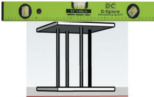
Gambar 3.69 Penggunaan Waterpas untuk Pengujian Level Horizontal
