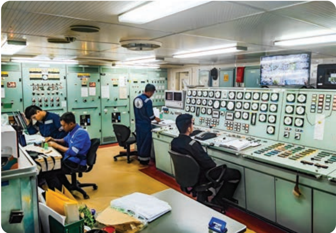
Gambar 4.13 Mengawasi permesinan melalui Engine Control Room (ECR)
