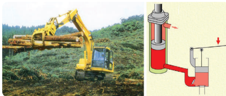
Gambar 4.20 Holding pressure pada sisi aktuator
