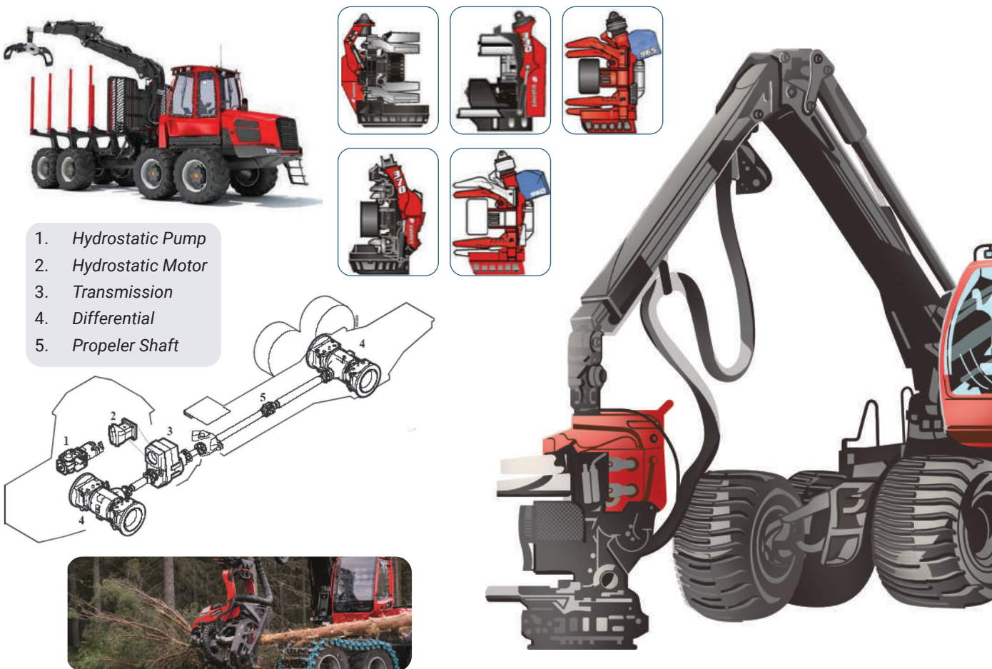
Gambar 1.45 Harvester dan bagian-bagiannya.
