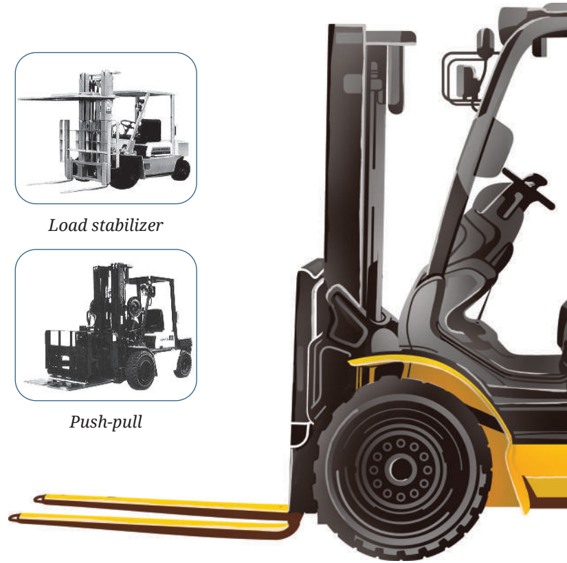
Gambar 1.39 Forklift dan perlengkapan kerjanya
